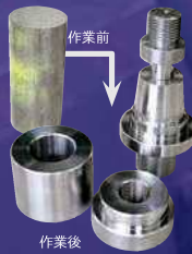
▼ただの鉄が今泉さんの旋盤作業でひとつの部品になる。
