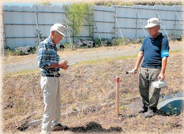
仮置場に設定されているモニタリングポイントで空間放射線量率を測定し、その値を記録しています。
