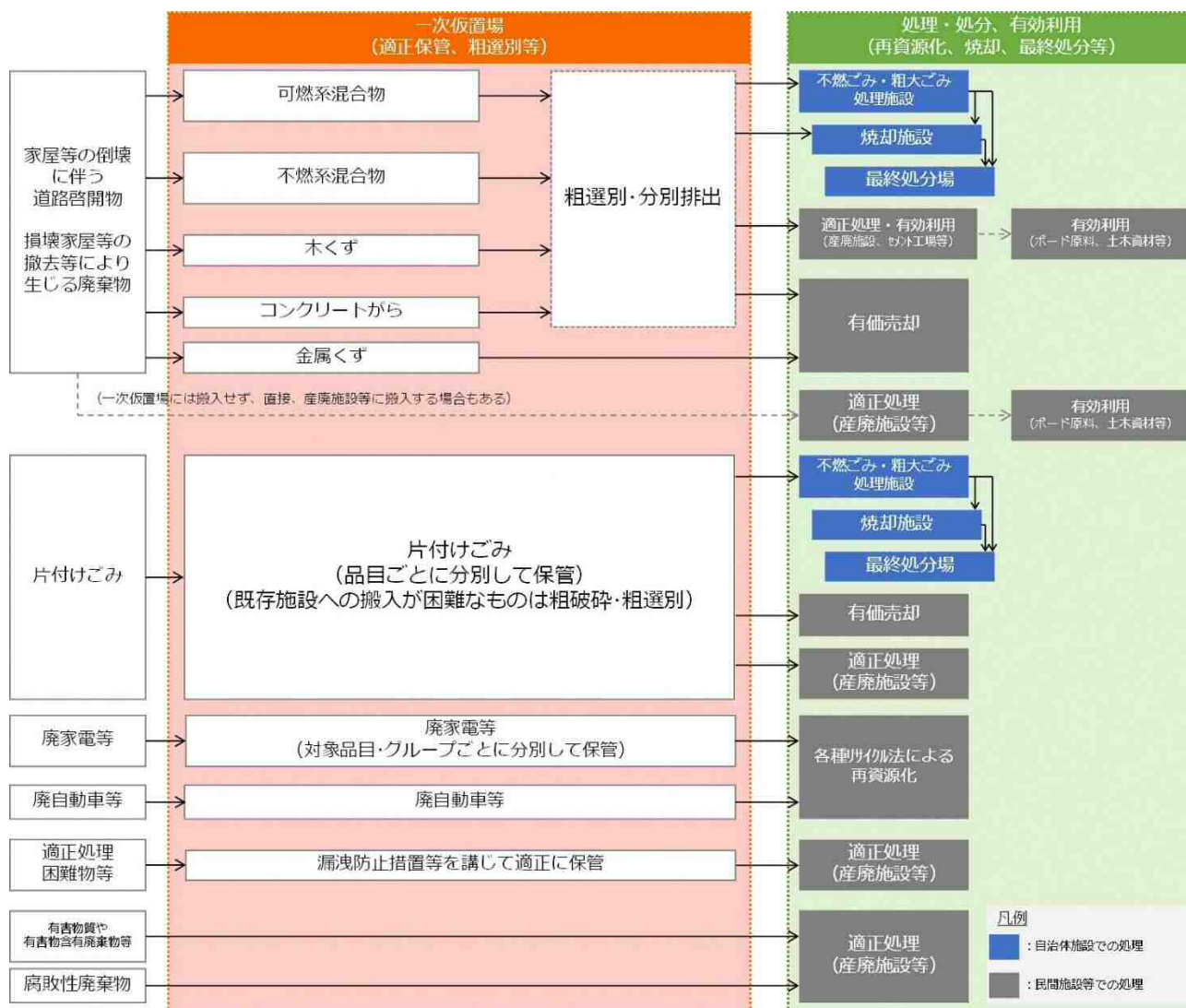
図表6-12(1) 災害廃棄物の処理フロー（二次仮置場を設置しない場合）
